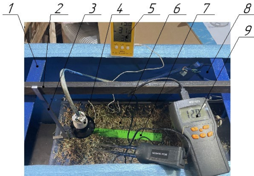
1 – крепление; 2 – поперечина; 3 – штангенциркуль; 4 – керамический ИК-нагреватель; 5 – метеостанция Thermo hygrometer DC 105; 6 – ленточный транспортер; 7 – линейка; 8 – стенка сушильной камеры; 9 – измеритель влажности зерна MD7822
