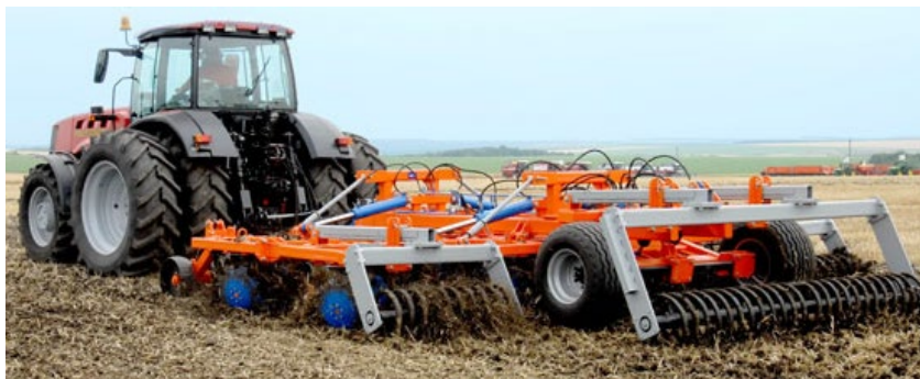
Рис. 1 – Агрегат дисковый АДУ-6А (Белагромаш-Сервис им. В.М. Рязанова)
